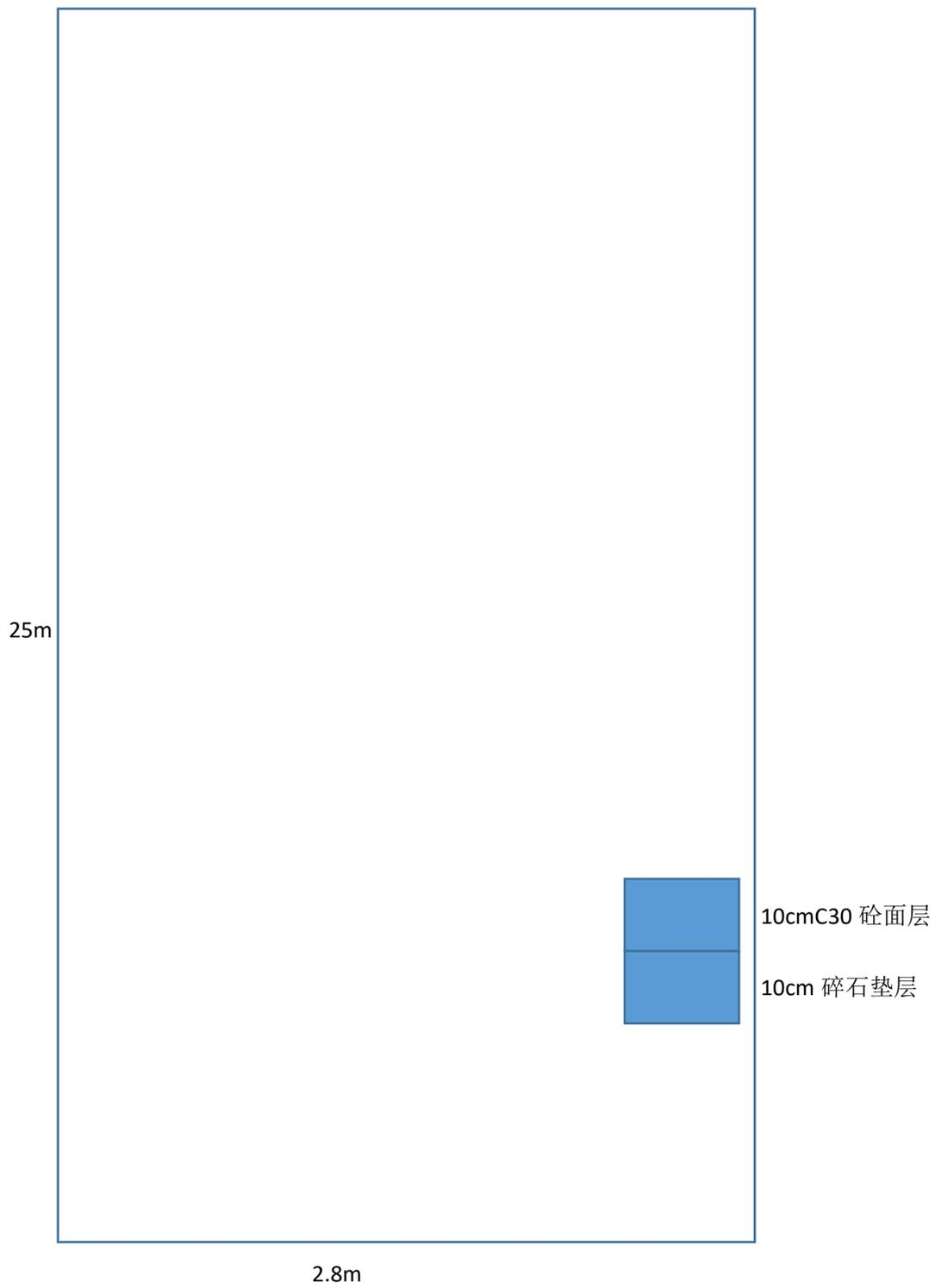
混凝土场地平面图
